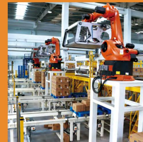
封箱码垛全自动化流水线
